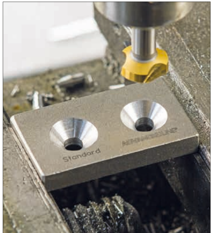
Die neue ADVANCEDLine Kegelsenker-Generation verhindert eine ungleiche Abnutzung der Schneidkanten, hat höhere Standzeiten sowie einen schnelleren Senkprozess. (Fotos: EXACT)
